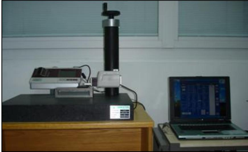
Figura 4.8 Rugosímetro de superficies Mitutoyo SurfTest SJ 401.
