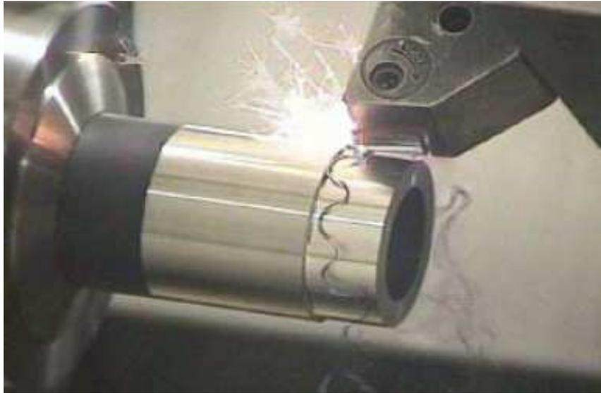
Figura 6.2. Fotografía de un proceso de corte ortogonal sobre una pieza (Coromant Sandvik, 2008)
