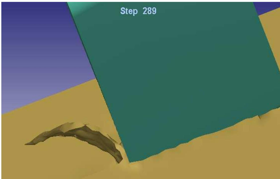
*Figura 8.98 Morfología de la viruta obtenida para la simulación con  $p=2$   $f=0,1$   $V_c=150$   $m=0,4$  sin implementar *Dcr**
