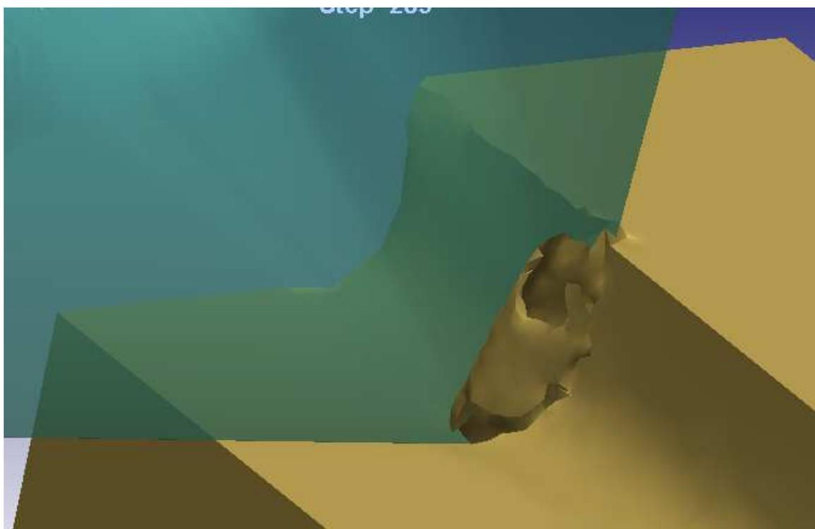
*Figura 8.100 Morfología de la viruta obtenida para la simulación con  $p=2$   $f=0,1$   $V_c=150$   $m=0,4$   $D_{cr}=0,05$*
