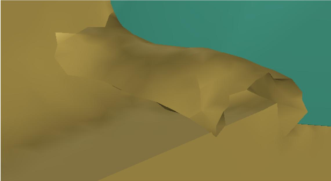
Figura 8.69 Viruta tridimensional utilizando criterio de fractura  $D_{cr}=0,18$
